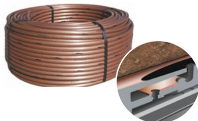
Idéal pour l'irrigation enterrée de gazon, d'arbustes ou de couvre-sol. Écartement des goutteurs 33 cm. Pression de 0,6 à 4 bar. Débit 2,3 L/h par goutteur. La technologie Copper Shield protège les goutteurs contre l'intrusion des racines.
