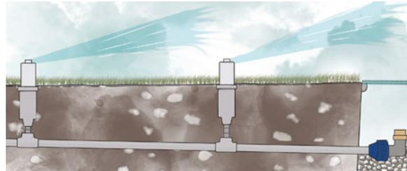
La soupape sert de purge permettant d'éviter les ruptures dues au gel. Elle permet aussi d'éviter le flaquage des arroseurs aux points les plus bas, lorsque les réseaux sont à différents niveaux. Ouverture automatique lorsque la pression est inférieure à 0,2 bar. Filetage mâle 15/21.
