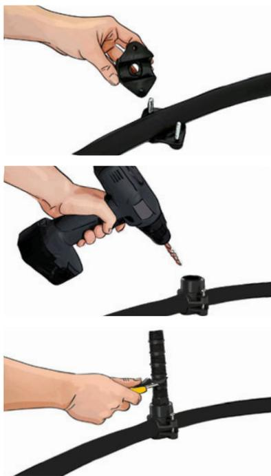
1. Mettre la partie inférieure du collier sous le tuyau. Placer le joint d'étanchéité dans le logement prévu de la partie supérieure du collier. Serrer l'ensemble du collier avec les vis fournies.
