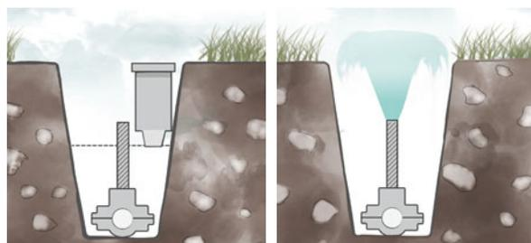
1. Percer et ajuster l'allonge en hauteur.
