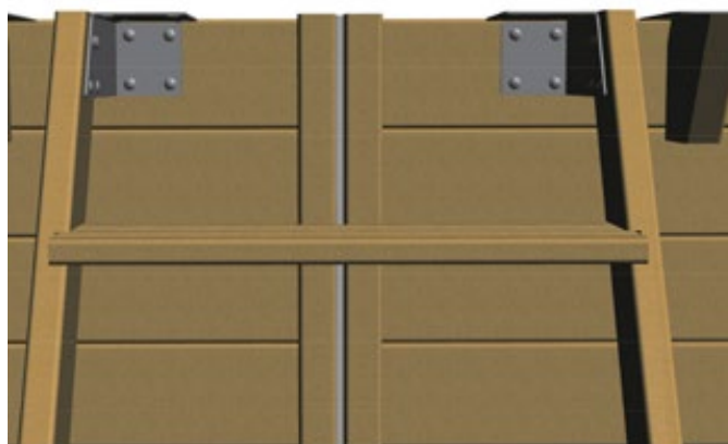
Figure 16 – Fixation de l'escalier extérieur sur le bassin
