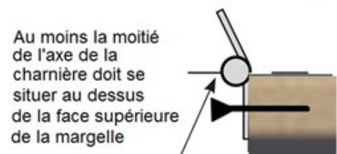
Figure 64 – Fixation des charnières
