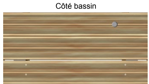
Figure 66 – Fixation du caillebotis
