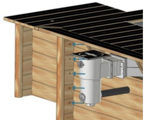
Figure 63 – Fixation du coffre sur le bassin
