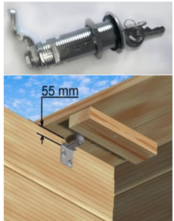
Figure 67 – Montage de la serrure
