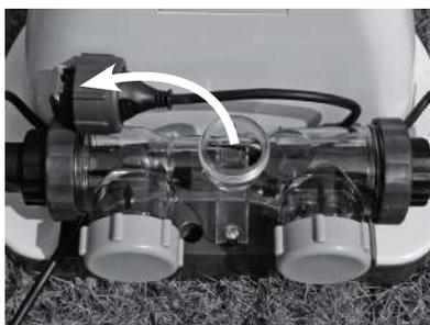
5. Verser du vinaigre d'alcool dans le boîtier de la cellule d'électrolyse (3) jusqu'à immersion des électrodes. Laisser tremper pendant environ 1 heure.
