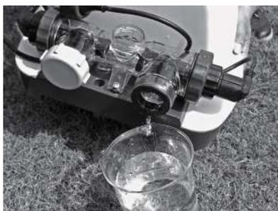
7. Raccordez la cellule électrolytique en suivant les étapes 3, 4, 5 et 6 à l'envers.
