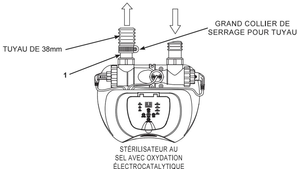
1. Raccordez l'adaptateur A (1) à l'écrou de sortie de la cellule électrolytique (3). Serrez fort.
