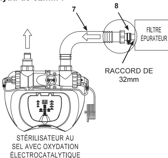
1. Raccordez l'adaptateur B (8) au tuyau de raccord (7). Serrez fort.
