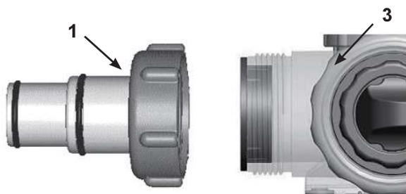
3. Détachez le tuyau de refoulement du filtre épurateur et raccordez-le à l'adaptateur A (1) de l'électrostérilisateur, avec un raccord tuyaux (voir Figure #1).
