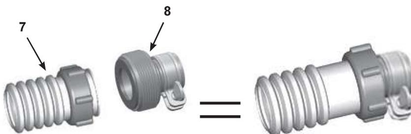
5. Raccordez l'adaptateur B (8) au tuyau de sortie du filtre épurateur (la sortie basse). Serrez fort.
