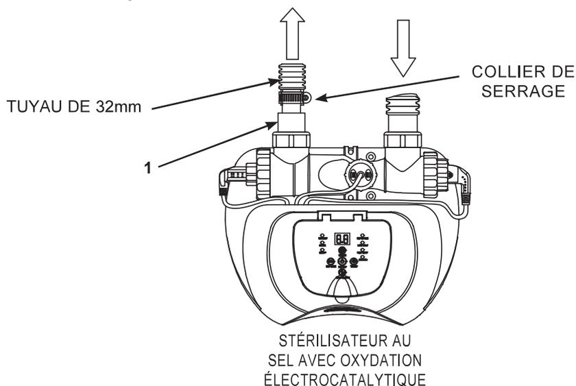
1. Raccordez l'adaptateur A (1) à l'écrou de sortie de la cellule électrolytique (3). Serrez fort.
